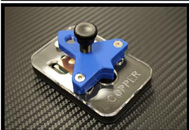
ロケット型のパーツを載せて2か所のミニボルトを締め、最後に大ボルトでHISを締め付けていきます。
