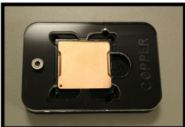
CopperIHSを載せます。そっと載せて下さい。画面のHSの左下のマーキングしている穴とCPU基板のマーカーを合わせるようんしてください。
