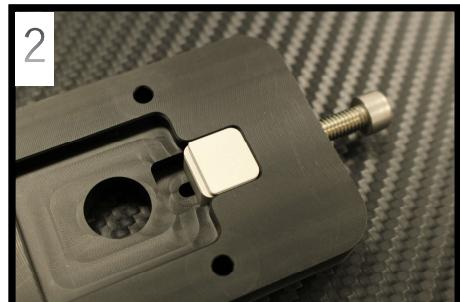
使用前に、本体から伸びている大きなネジを緩め、プレートをネジ側へ下げるときて下さい。
