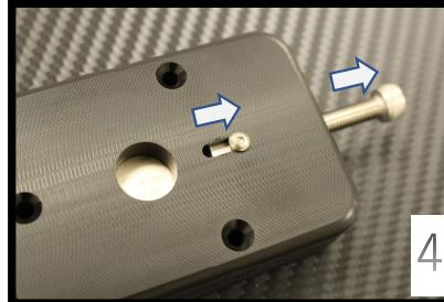
ネジが付属している側と、CPUを設置した側を合わせます。
